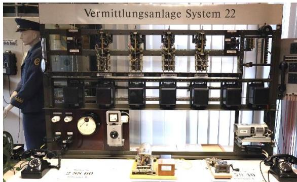
*Vermittlungsanlage System 22 mit der oben beschriebenen Ruf- und Signalmaschine: Das System 22 der Fa. Siemens & Halske stammt aus dem Jahr 1922. Es ist das älteste Vermittlungssystem, das wir in Funktion zeigen können. Zu jedem der Teilnehmer gehört neben dem Telefon ein Vorwähler und ein Gesprächszähler.*
