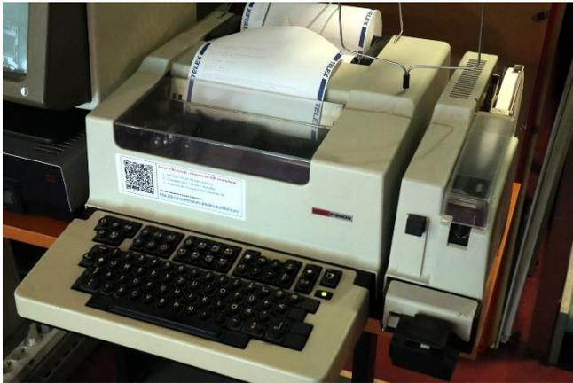
Erstmals wurde (in der DDR) bei einem Fernschreiber ein Mikroprozessor (U880) eingebaut. Der F 2000 hat einen Textspeicher für 8000 Zeichen (ca. vier Seiten) und einen Eingangspuffer von 6000 Zeichen, damit beim Papierwechsel keine Daten verloren gehen. Typische Arbeitsgeschwindigkeiten liegen bei 50, 75 oder 100 Baud. Gedruckt wurde mit einem Nadeldruckwerk, bestehend aus 12 Nadeln und Spulenfarbbändern, die zur Verhinderung des Austrocknens gekapselt waren.
