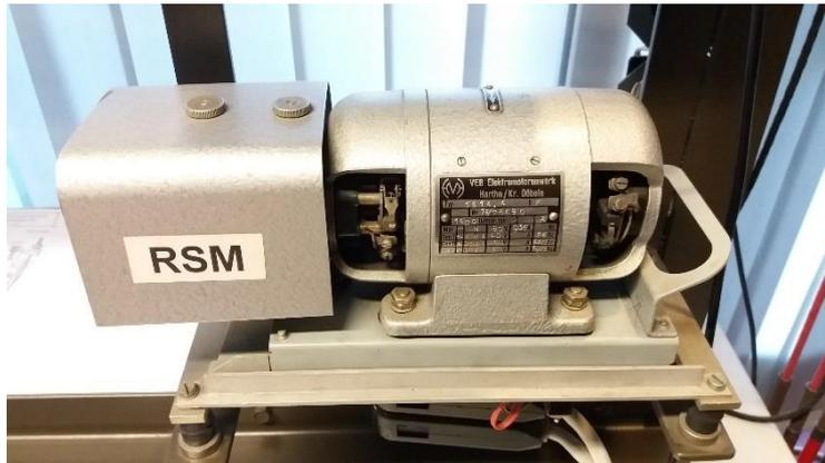
Die Ruf- und Signalmaschine (RSM) wurde in analogen Vermittlungsstellen und Telefonanlagen eingesetzt. Sie erzeugt die Rufwechselspannung von 25 Hz und den Hörton von 450 Hz, außerdem Wähl-, Frei-, Besetztöne und das Fernamts-Aufschaltezeichen.
