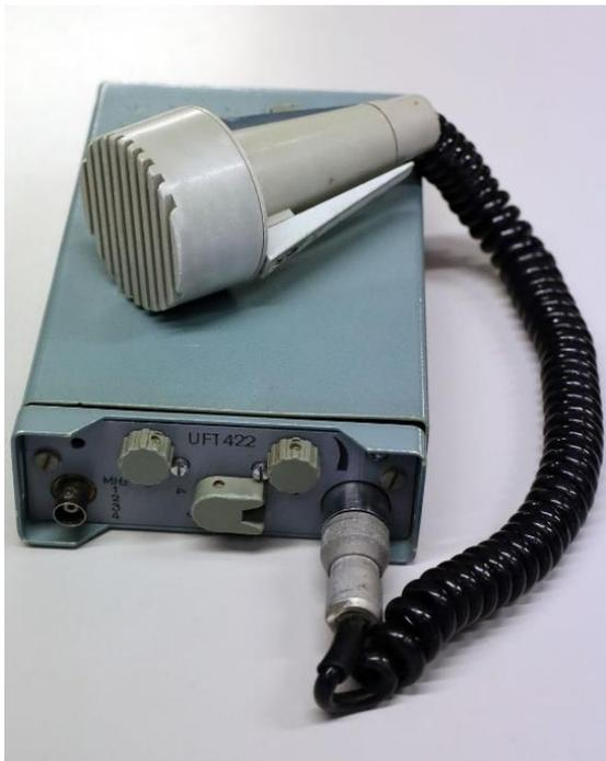
Das Handfunksprechgerät UFT 422 wurde bis 1980 gebaut. Es nutzt vier Kanäle im 2 m-Band.
