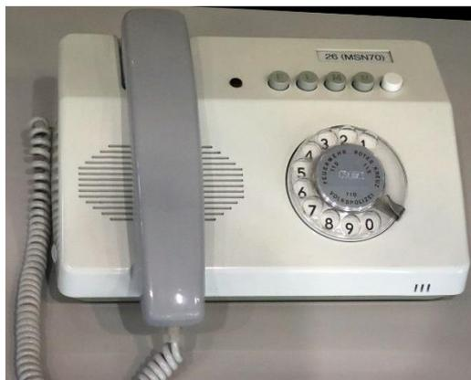
Lautfernsprecher sind mit Lautsprechern ausgestattet, die das Telefonieren ohne Handapparat ermöglichen. Damit können sich auch weitere im Raum befindliche Personen am Gespräch beteiligen. Um ggf. auftretende Rückkopplungen zu minimieren, sind spezielle Schaltungen erforderlich.
